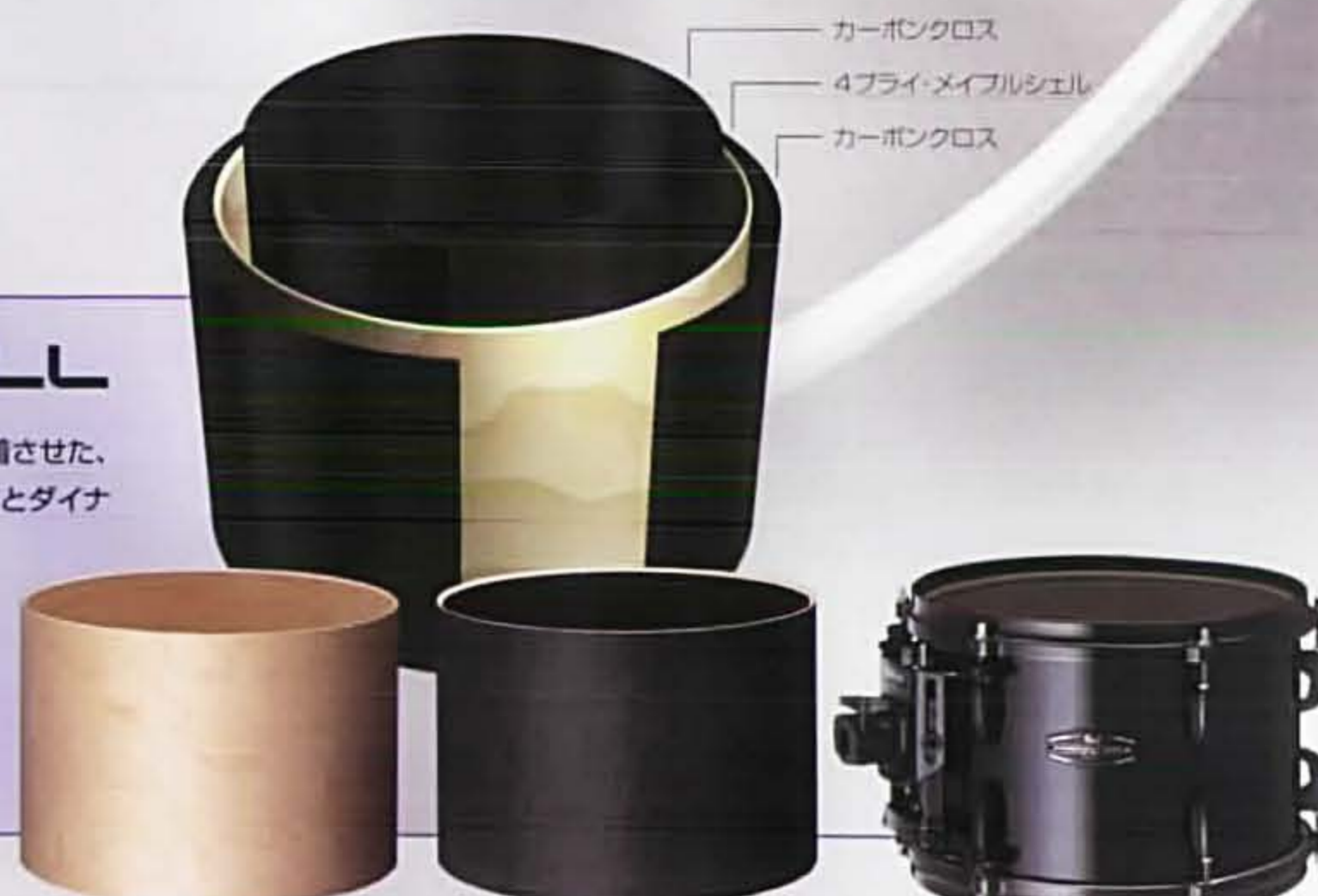
▶ 4プライ・メイプルシェル ▶ シェルの両面にカーボンクロス(炭素繊維)をポリエステル樹脂でラミネート ▶ カーボンクロスの素材感にマッチする、標準のブラックパーツ
